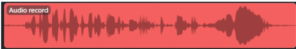
*Gute Aufnahme: Keine Übersteuerung und ein durchschnittlich mittlerer Pegel*
